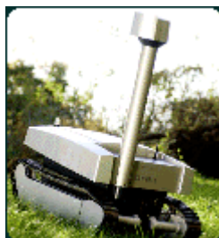
OFRO. Robot de vigilancia exterior para áreas amplias. Robowatch ( http://www.robowatch.de:8080/home/en/products.jsp ).
