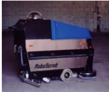
RoboScrub, robot de limpieza industrial guiado por láser. Denning Branch International (Australia, http://www.southcom.com.au ).
